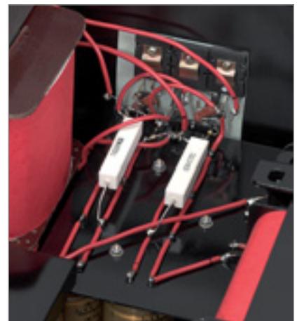
Sind allein für den Strom zuständig: die Leistungstransistoren der Endstufe
